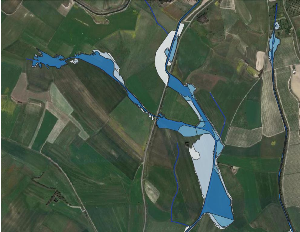
Figura 9. Risultanze della modellazione idraulica per i vari tempio di ritorno
